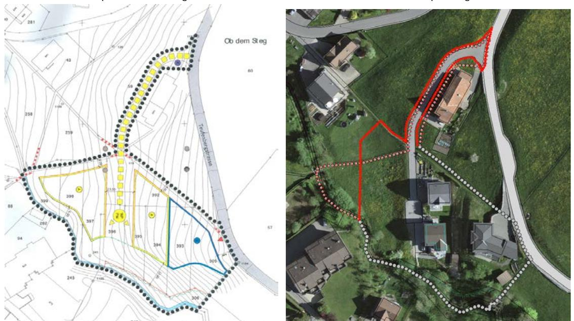
Die tatsächliche gebaute Erschliessungsstrasse verläuft leicht nordwestlich im Vergleich zum geplanten Verlauf nach Quartierplan Ob dem Steg vom 29.02.2002. Diese Diskrepanz wurde mit der Änderung des Überbauungsplans behoben und der Perimeter zwischen Teufenbergstrasse und den Baubereichen angepasst. Da die Erschliessungsstrasse zum Überbauungsplanperimeter gehört, wird die Strasse in der nächsten Zonenplanrevision der Verkehrsfläche innerhalb Bauzone zugewiesen.
